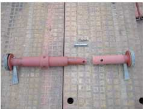
連結ピン先端の穴に松葉ピンを差込んでください
