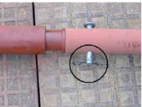
連結ピン先端の穴に松葉ピンを差込んでください
